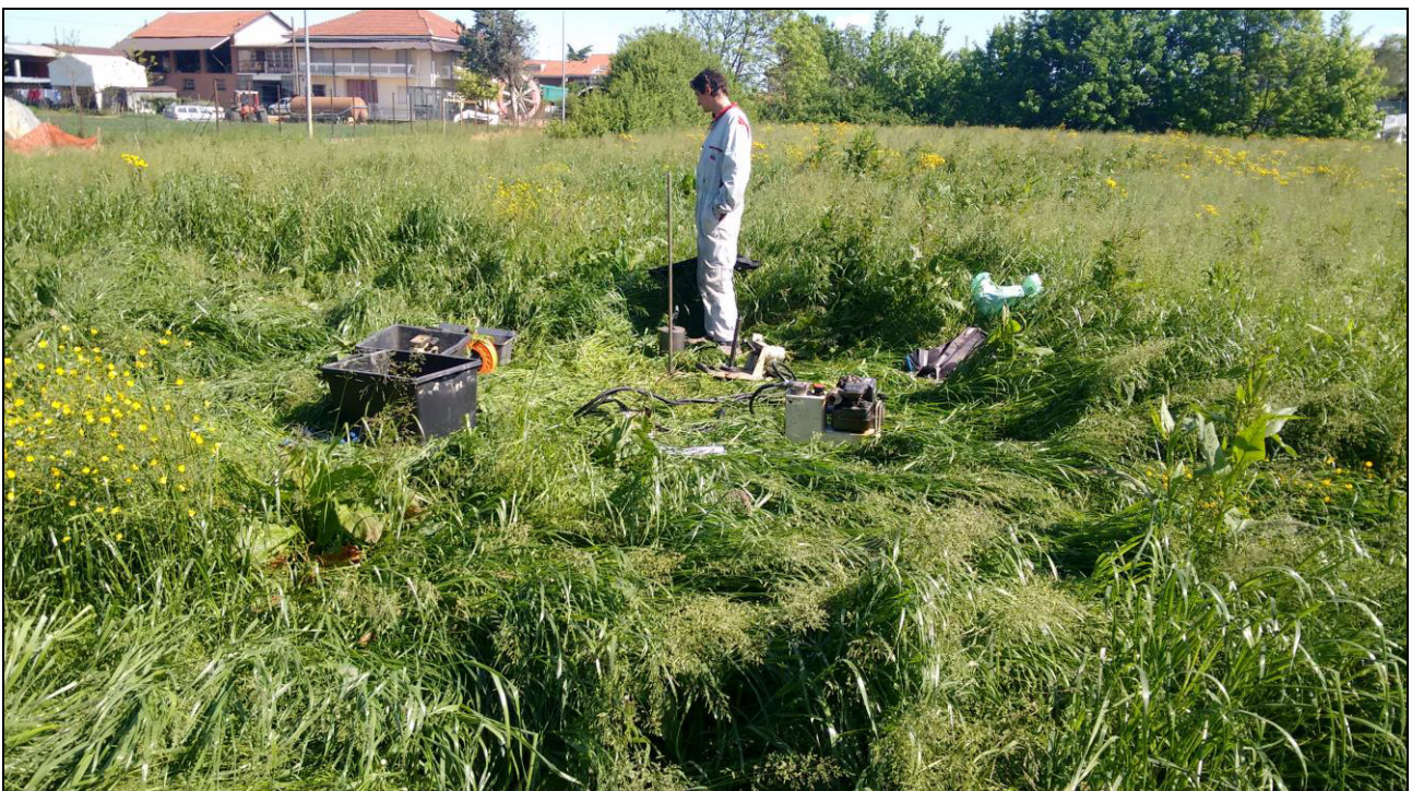
Esecuzione della Prova DPL 1
