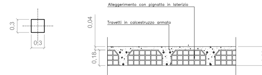
PARTICOLARI COSTRUTTIVI PILASTRI GETTATI IN OPERA SOLAIO IN LATEROCEMENTO PER LOCALE DISINFEZIONE
