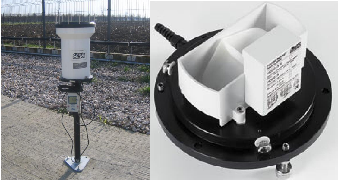
Figura 5 -Pluviometro a vaschetta basculante.
