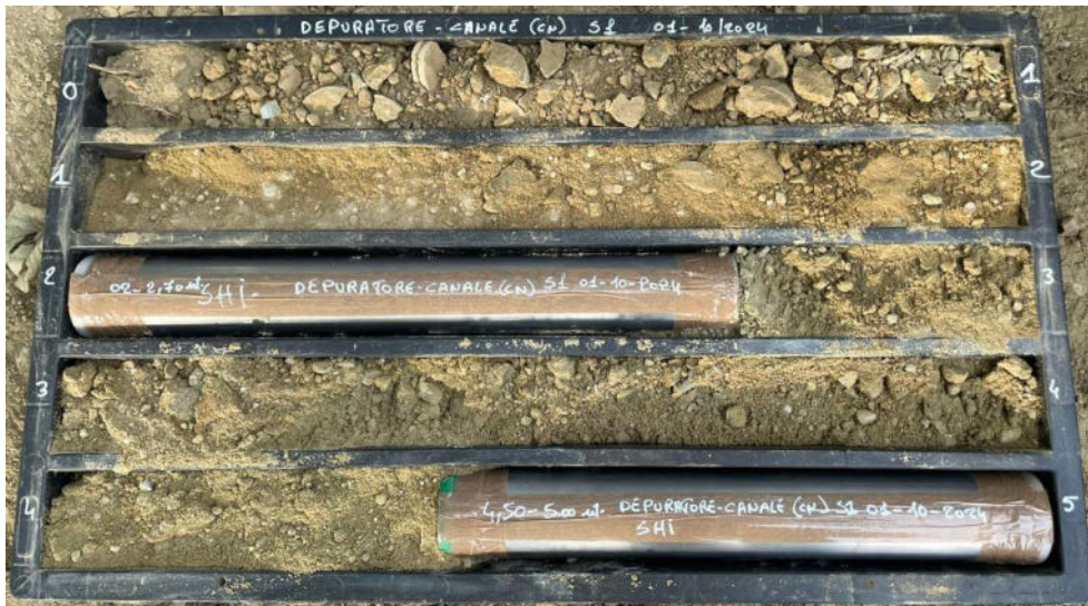
Impianto di depurazione - CANALE (CN) - S1 CASSETTA Da 0.00m a 5.00m
