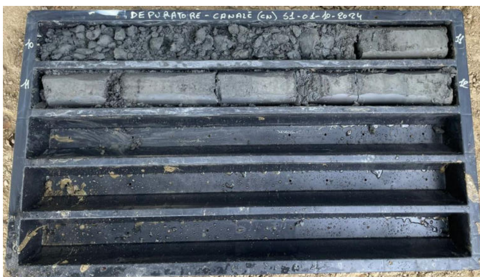
Impianto di depurazione - CANALE (CN) - S1 CASSETTA Da 10.00m a 12.00m
