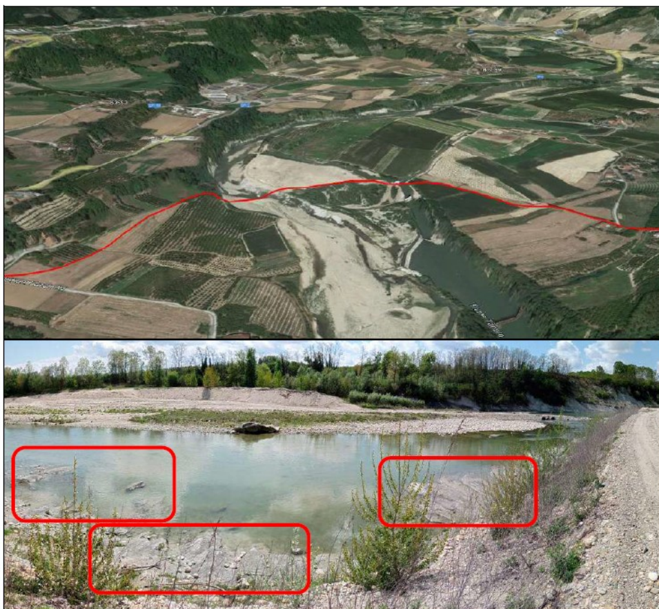
Figura 48: attraversamento del F. Tanaro; nella foto sono indicati affioramenti di substrato del B.T.P. in alveo
