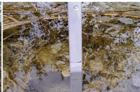
Foto 14: Abbassamento dei livelli durante il pompaggio
