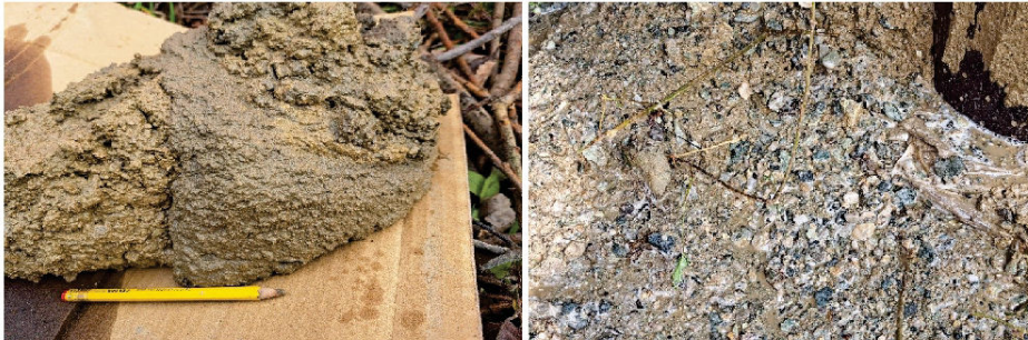
Foto 5: i depositi argillosi saturi nei primi metri di scavo Foto 6: le ghiaie grossolane intercettate in profondità
