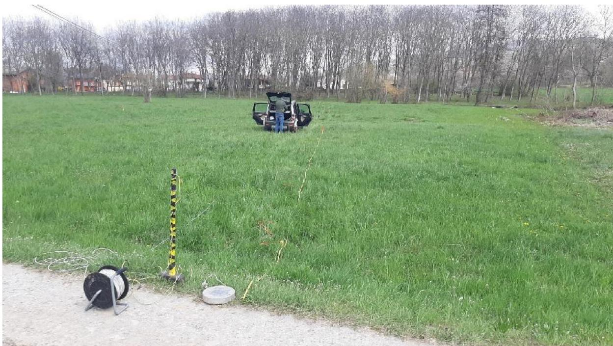
▪ Foto 2 – Esecuzione sismica a rifrazione S1 e acquisizione MASW
