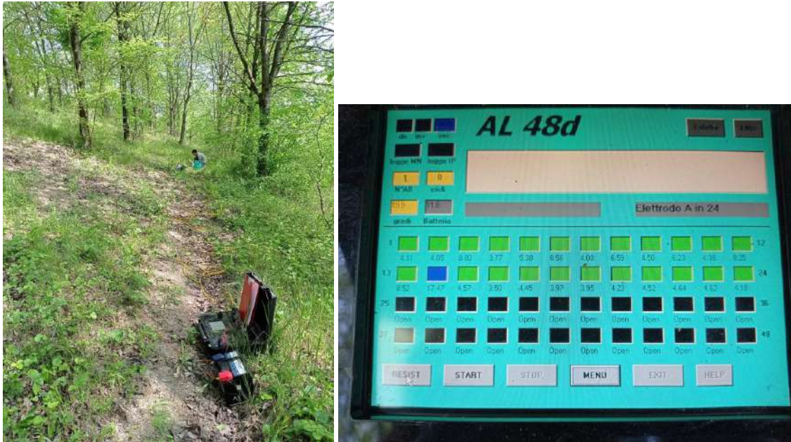
Figura 18: acquisizione di linea geofisica elettrica (a sx. apparato disposto sul terreno, a dx. display dello strumento in assetto di misura)
