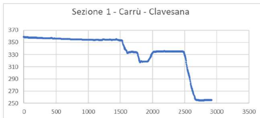
Figura 23: sezione topografica trasversale al tracciato acquedottistico, nel settore tra Castelletto di Piozzo (altopiano a sx.) e il F. Tanaro a valle di Farigliano (a dx.)
