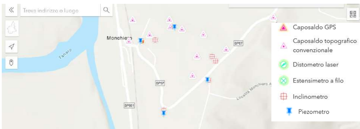
Figura 41: stralcio dal Sistema informativo di monitoraggio controllo frane di ARPA Piemonte) ReRCoMF
