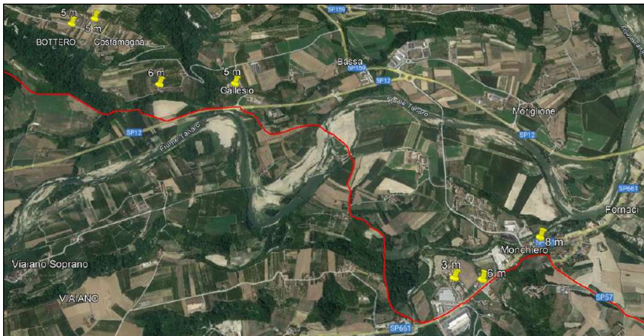
Figura 28: censimento dei pozzi da autodenunce ex D. Lgs. 12 luglio 1993, n. 275; tratto di condotta in progetto tra Lequio Tanaro (a sx.) e Monchiero (a dx.), con indicazione della profondità di scavo.
