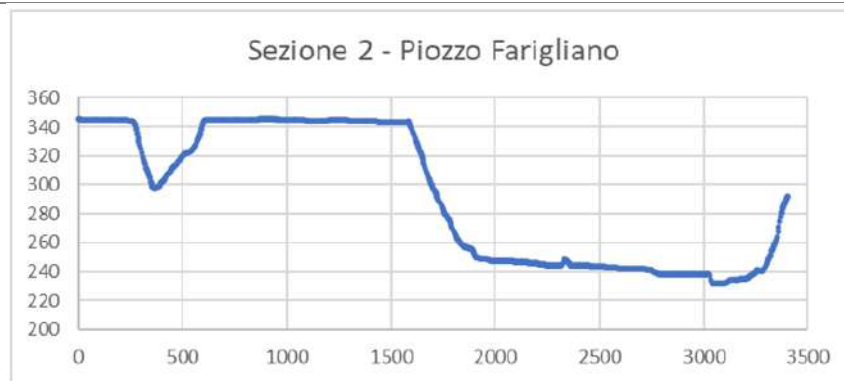
Figura 24: sezione topografica trasversale al tracciato acquedottistico, nel settore tra Carrù (altopiano a sx.) e il F. Tanaro a valle di Clavesana (a dx.)
