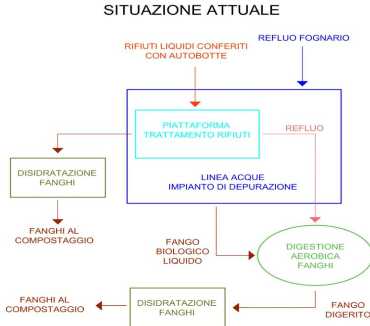
*Figura 3 – Schema di flusso dell'impianto di depurazione esistente*
