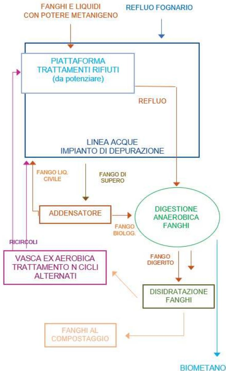
*Figura 4 – Schema di flusso dell'impianto di depurazione in progetto con produzione biometano*
