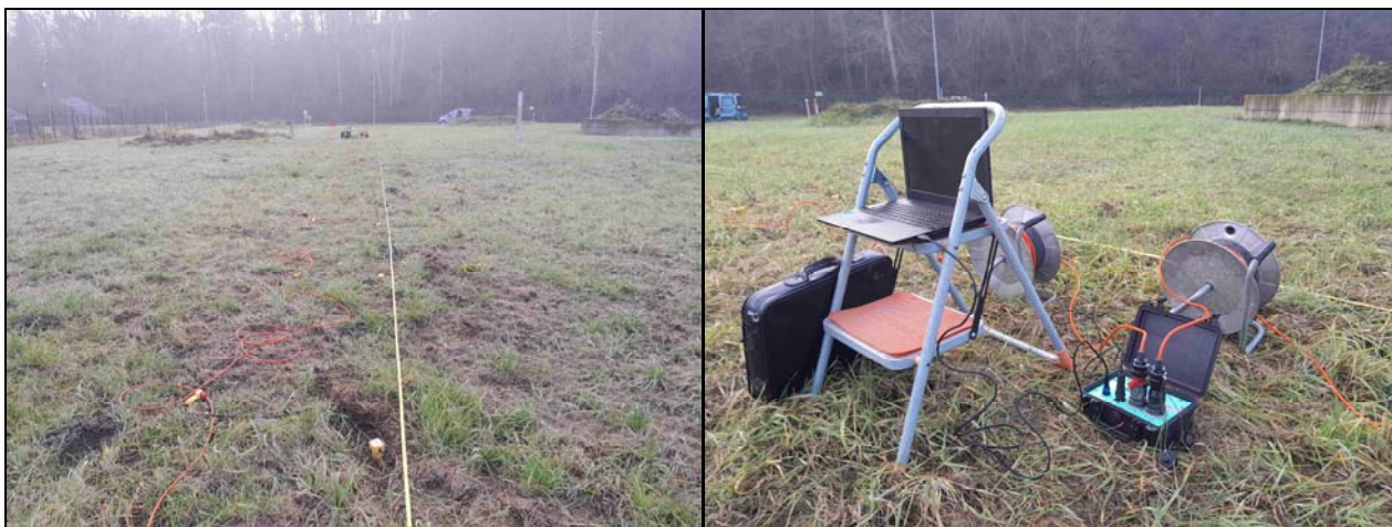
Fig. 4.1-1: Documentazione fotografica indagine MASW vista da NO (a sinistra) e dettaglio apparecchiatura di acquisizione (a destra).
