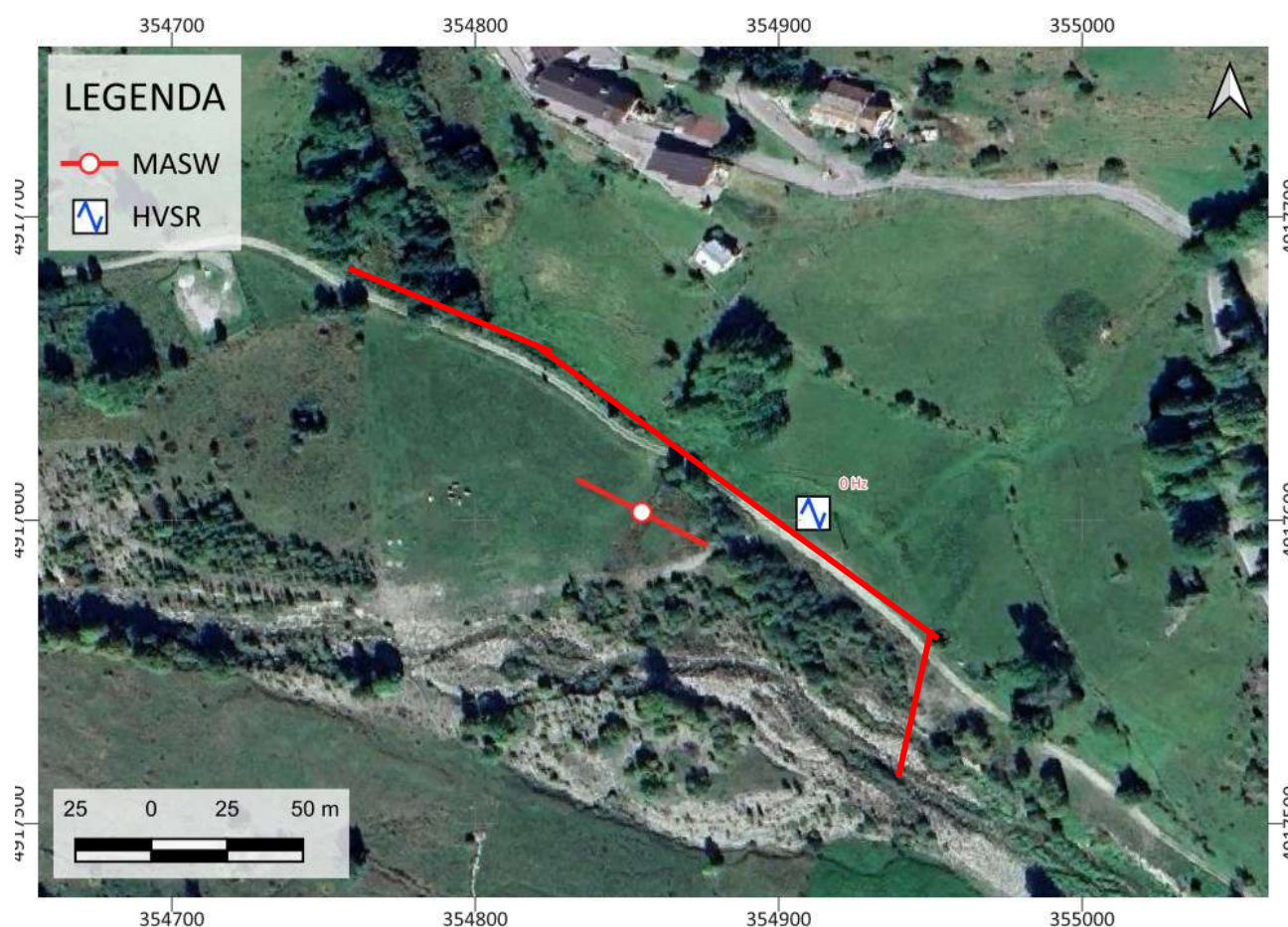
Figura 8 - Ubicazione delle indagini geofisiche e ubicazione delle condotte in progetto. Google Satellite 2024, scala 1:2.500.
