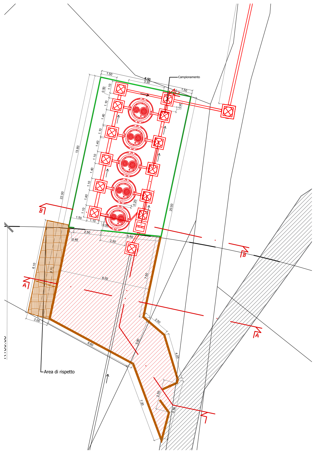
PLANIMETRIA DI PROGETTO IMPIANTO DI DEPURAZIONE - SCALA 1:200 -
