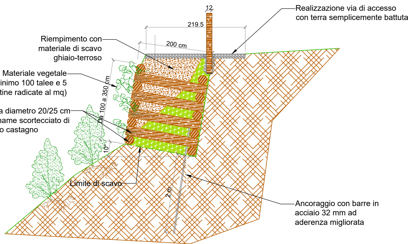
SEZIONE TRASVERSALE TIPO PALIFICATA Scala 1:50
